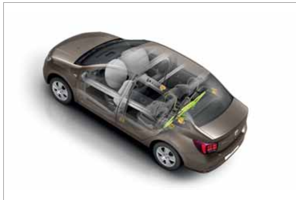
Zaštita: ojačana karoserija, prednji i bočni zračni jastuci za vozača i suvozača te sustav za pričvršćivanje dječjih sjedala Isofix na bočnim stražnjim sjedalima.
